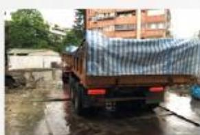
使用密封車輛運送濕土，或在運送乾土時覆蓋防塵膠布，防止沿途揚塵。
